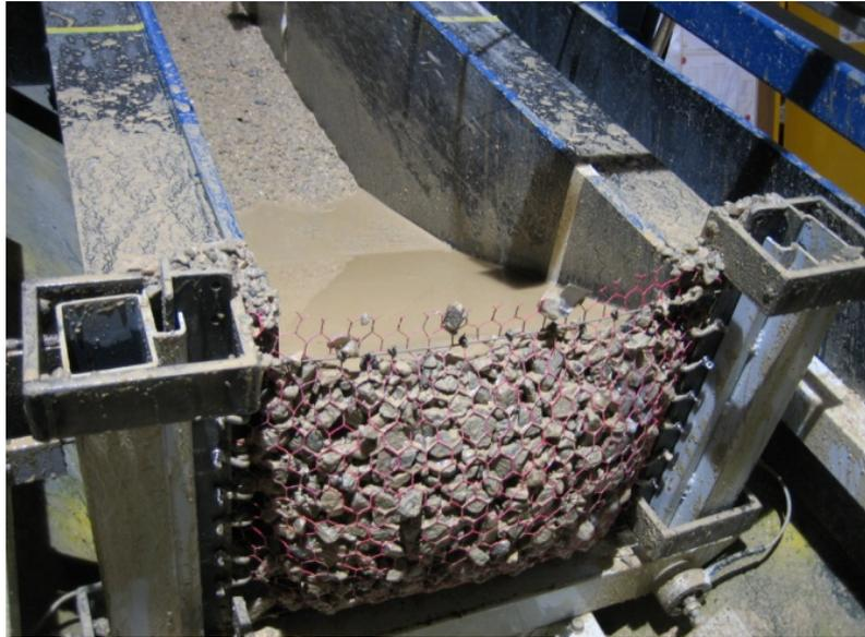
**Figura 33 – Ilustração da barreira flexível proposta para contenção de resíduos**
