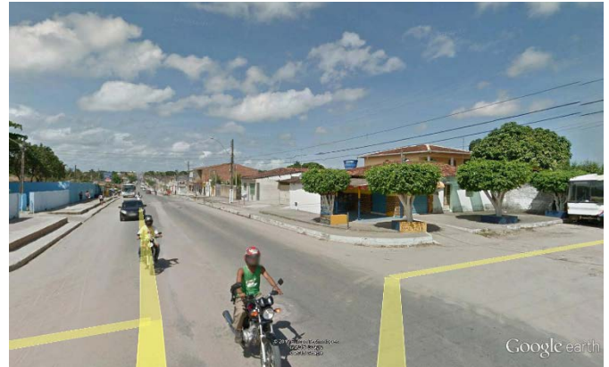
Figura 79 – R. Santana x R. Dr. Jones Castro Castelo (bairro Tabuleiro do Martins) – calçadas com piso irregular, guias altas fora de padrão e ausência de faixas de travessia e ilhas físicas de proteção (refúgios)
