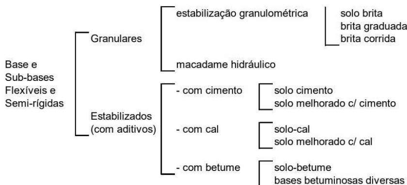
Figura 26 - Classificação das bases e sub-bases flexíveis e semi-rígidas
