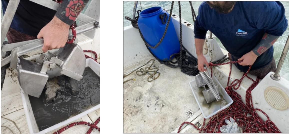
**Figura 1.** Coleta de sedimento realizada com draga *Van Veen* na área da jazida sedimentar.
