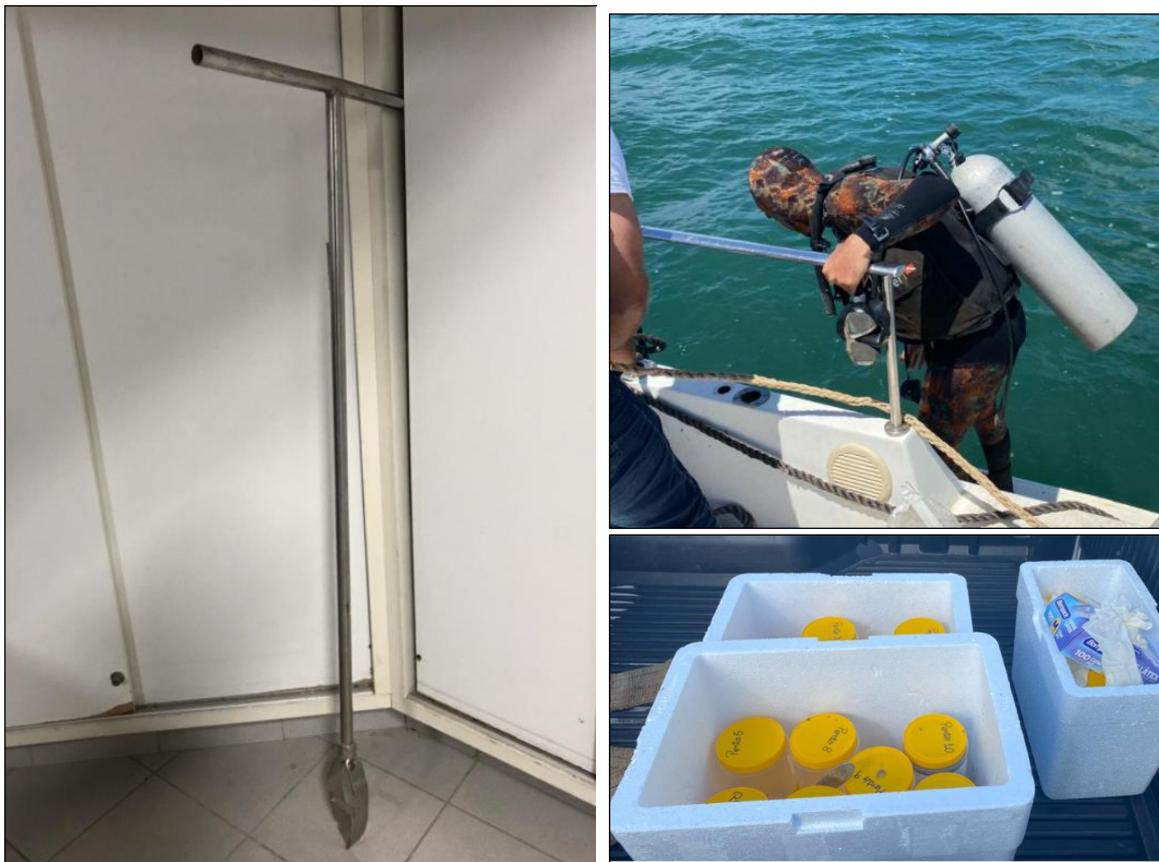
**Figura 2. Coleta de sedimento realizada com amostrador do tipo trado e mergulhador na área da jazida sedimentar.**
