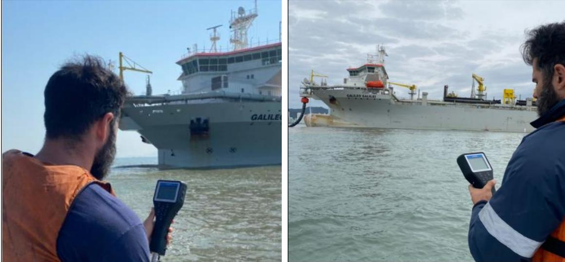
**Figura 6. Medição de turbidez com o uso de equipamento mutiparâmetro HORIBA.**
