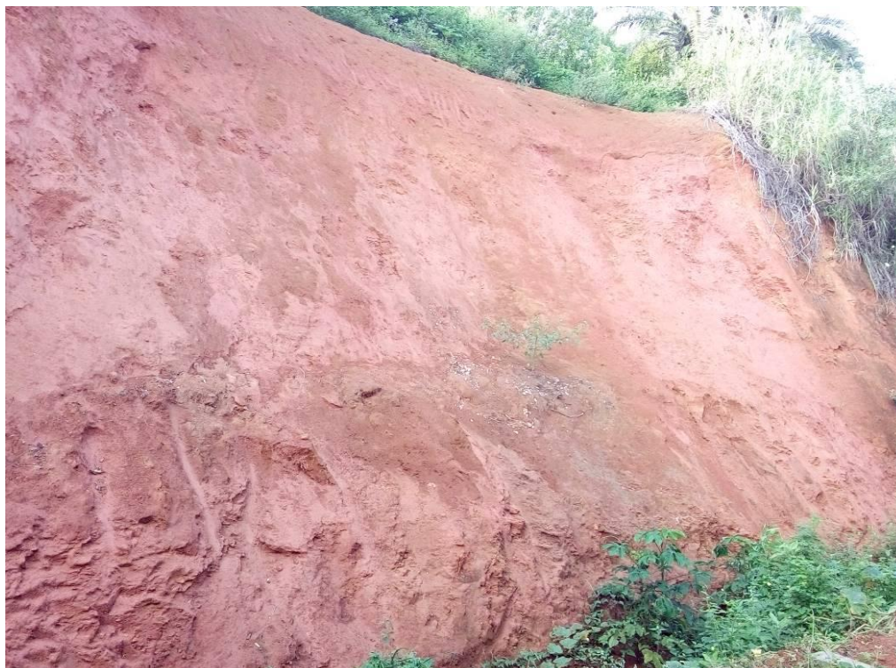
Figura 4.2 – Ocorrência de deslizamento superficial em um trecho do talude
