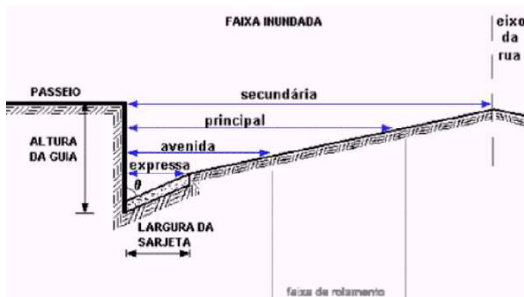
Figura 12 - Geometria da sarjeta
