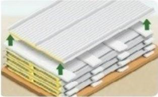
Para posicionar ou retirar um painel/telha de um fardo, levante-os sem puxá-lo, para não o arrastar sobre o painel/telha logo abaixo, solo, pisos, terças metálicas, longarinas ou na própria carroceria do veículo.
