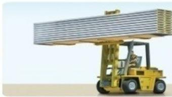
Ao manusear com empilhadeira, garantir que as lanças se apoiem na base do fardo de forma distribuída proporcionalmente ao dimensional do fardo conforme ilustração acima.
