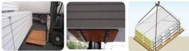
Portas, telhas e painéis podem ser carregados e descarregados com empilhadeira ou guincho, sempre apoiados sobre um tablado de madeira ou metal. Em caso de uso de empilhadeira, observe o tamanho e o distanciamento entre os calços e dos garfos/lanças (aprox. 1,100mm); em caso de uso de guincho, não permita que a cinta de fixação pressione a lateral dos painéis.
