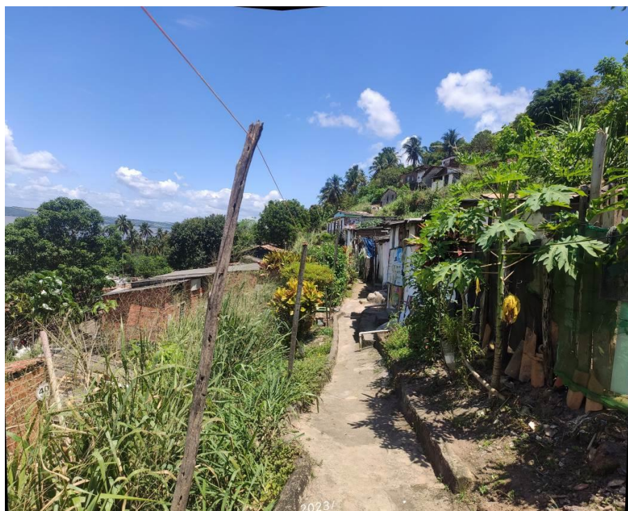
Figura 5.3.- Ponto 01/02 – Observa-se mais uma vez o estreitamento do acesso de moradores, desta vez, é possível identificar a presença de edificações presentes tanto na crista quanto no pé do talude, além do desnível entre as edificações a montante e a jusante.
