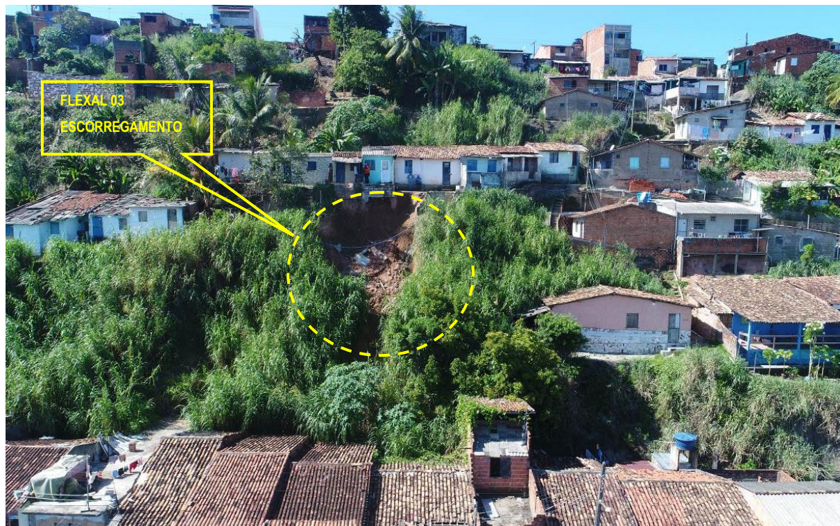
Figura 5.9.- Ponto 03 - Imagem de drone mostrando o escorregamento que envolveu uma grande massa de solo.
