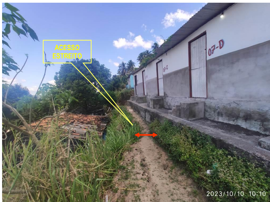
Figura 5.2.- Ponto 01/02 - Foto de um ponto da encosta em que, pode-se observar o estreitamento da via de acesso dos moradores, além do desnível entre a parte a montante e jusante do talude.
