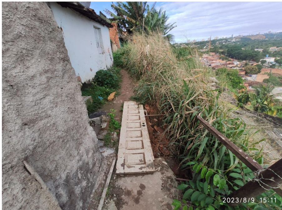
Figura 5.13.- Trecho de acesso interrompido pela ocorrência de escorregamentos (ponto de risco 04), travessia improvisada para permitir a passagem dos pedestres.
