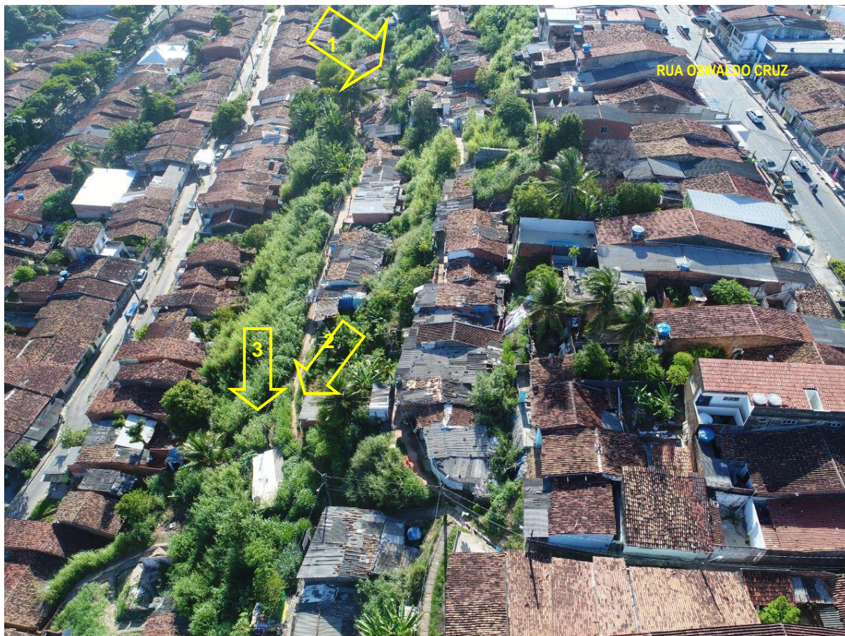
Figura 5.16.- Vista aérea da encosta, a seta 1 indica a posição do escorregamento ocorrido no ponto de risco 04, a seta 2 indica a escadaria que liga a meia encosta com a rua Oswaldo cruz, mostrada na figura anterior e seta 3 indica a posição do escorregamento ocorrido no ponto de risco 05. Observar o padrão -de ocupação caótica e desordenada da encosta.
