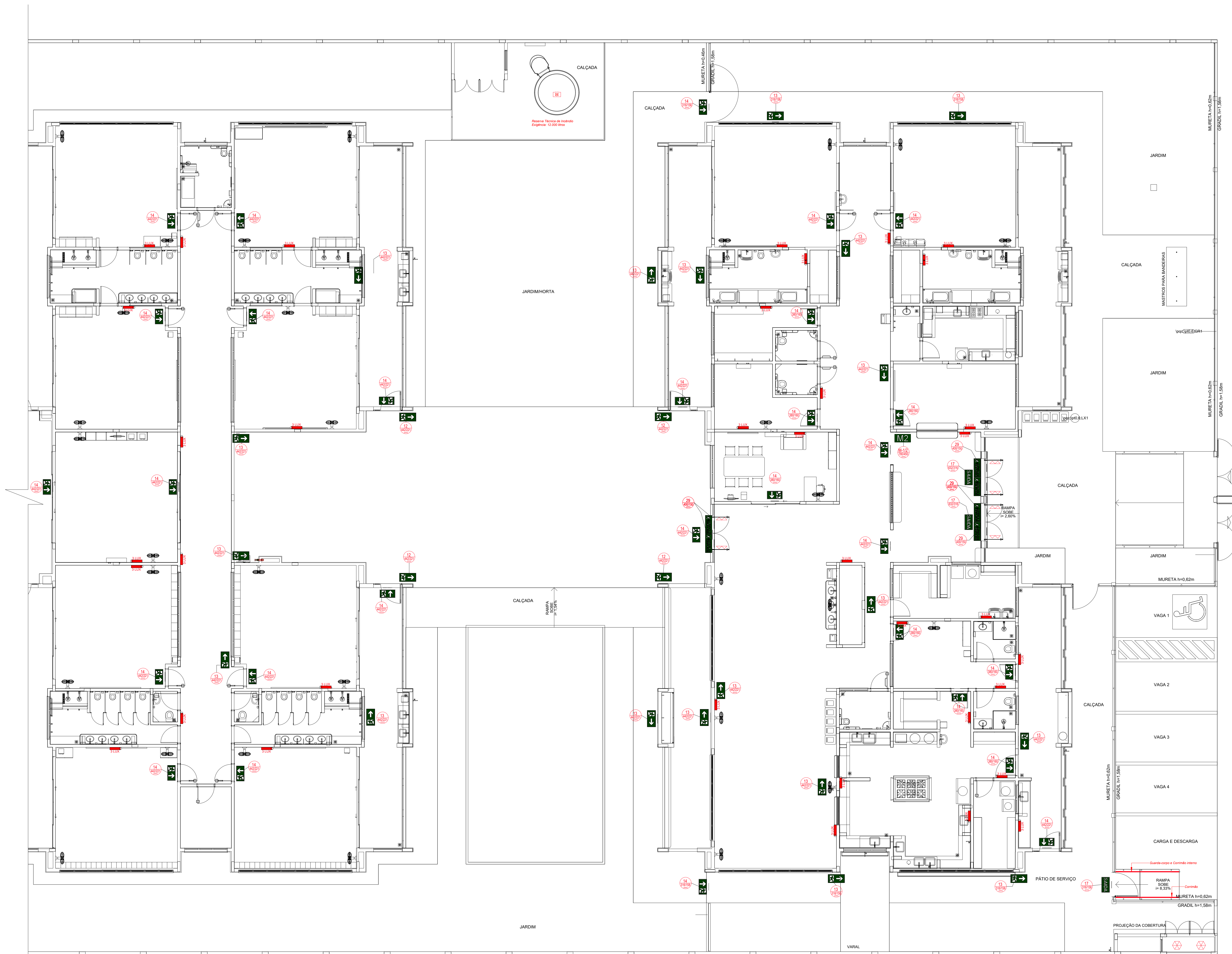
1 PLANTA BAIXA - SINALIZAÇÃO E ILUMINAÇÃO ESCALA 1/75
