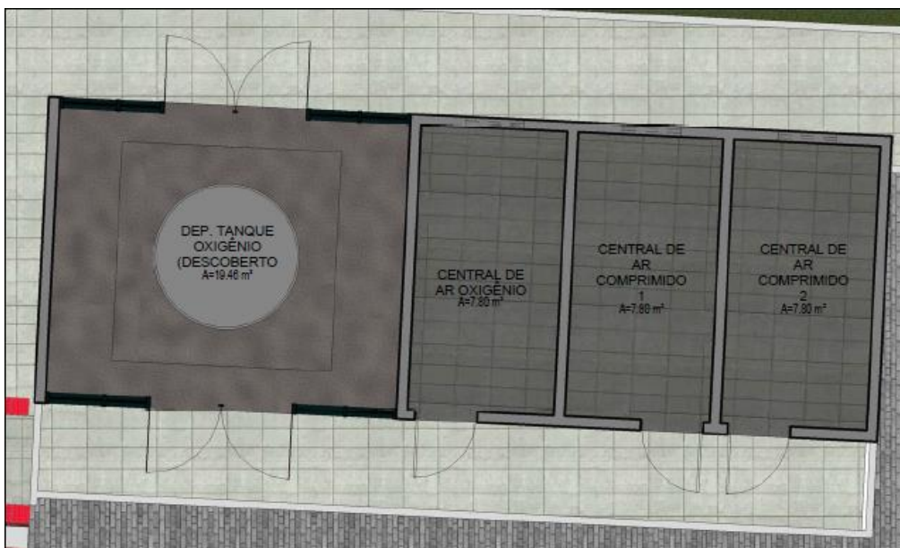
Imagem 15: Planta Baixa Pav. Térreo Edificação de Apoio – Centrais de Ar.
