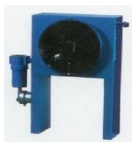
Do tipo resfriado a ar, localizado após o compressor de ar, resfria o ar comprimido, **removendo 70% dos contaminantes líquidos presentes no ar comprimido** através do separador de condensado do tipo ciclone, que combina a ação centrífuga e a separação por impacto, e do dreno automático, preparando o ar comprimido para ser purificado, proporcionando maior vida útil aos elementos filtrantes e do material adsorvente do secador.
