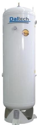
Para armazenamento de Ar Medicinal Comprimido gerado pela Central, dimensionado para atender a vazão e a pressão gerada, construído conforme norma **ASME Seção VIII, div I e NR-13 do Ministério do Trabalho**, com **tratamento interno anti-corrosivo**, garantindo total segurança aos usuários. Execução vertical, pressão máxima de operação 10 bar – 142 psig e pressão de teste hidrostático de 15 bar. Equipado com manômetro, válvula de segurança e dreno manual de condensado.
