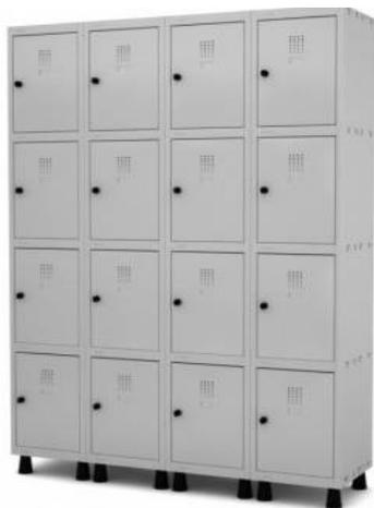
**Estrutura:** Número 22, com 16 (dezesseis) compartimentos sobrepostos (04 na horizontal e 04 na vertical), portas com bordas dobradas, com puxadores e fechaduras tipo yale, de segredo único, com ventilação e visor de identificação em cada porta, dobradiças embutidas. 04 pés em chapa de aço número 14, em formato de "I", nos cantos do escaninho.
