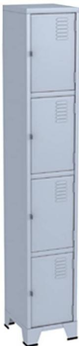
**Estrutura:** Armário confeccionado em chapa de aço zincada (galvanizada) lisa, conforme norma NBR 7008 ZC / X / Cristais normais. Laterais, fundo, portas, bandejas e prateleiras divisórias em chapa 0.65 mm (GSG – 24) – moldura (quadro frontal) em chapa 0.95 mm (GSG-20) e base em chapa 1.25 mm (GSG-18). Estrutura com transpasse em “U”, fixadas por rebites “pop” alumínio, alojados na estrutura, permitindo o alinhamento face a face das laterais dos armários.
